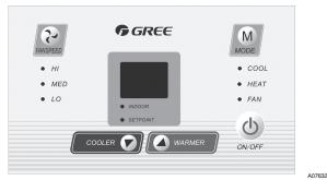
Fig. 50 - Keypad Controls
